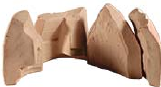
Motlle de guix amb les seves parts.
